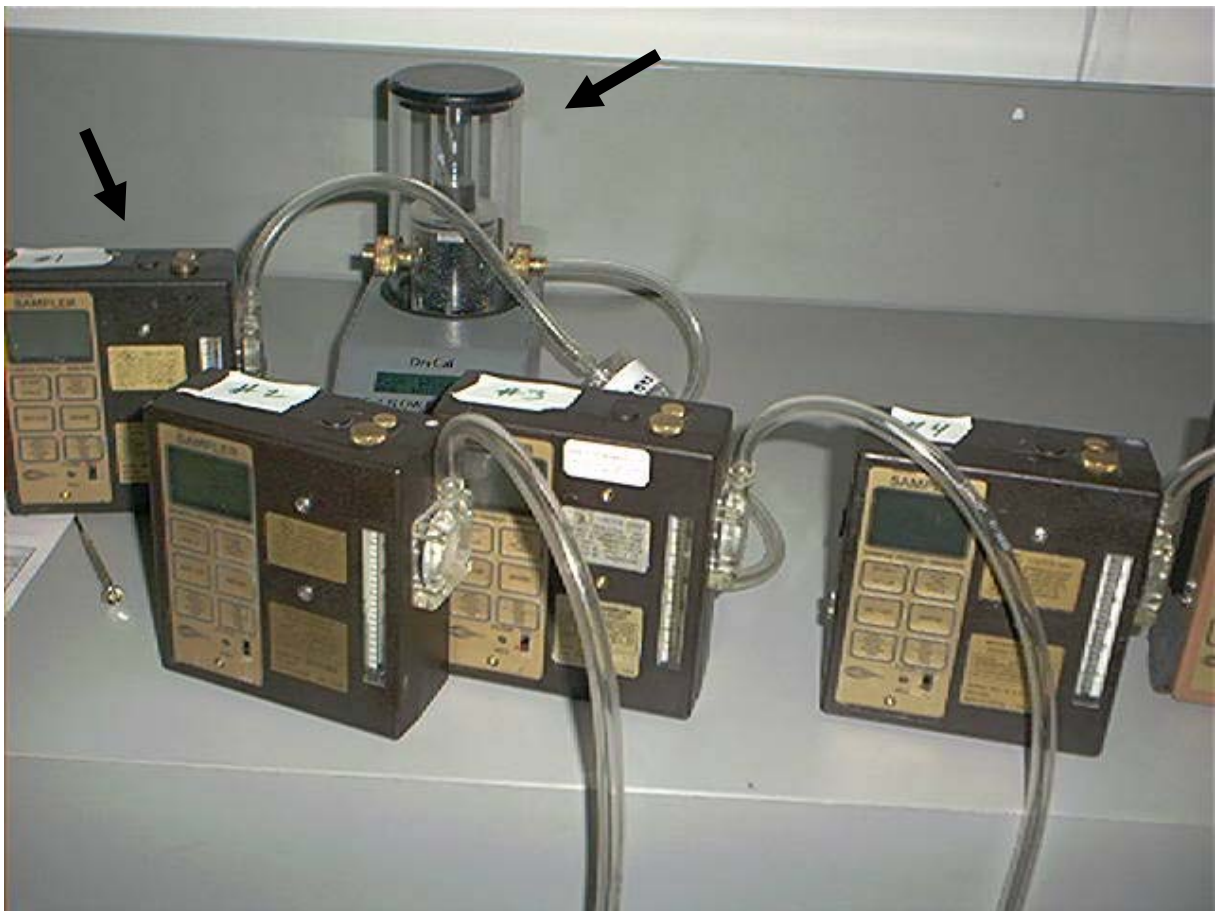
Fig. 11 Equipo de burbuja indicadora calibrando una bomba con filtro
